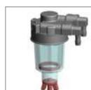
Il separatore di acqua e carburante di alta qualità, facile da rimuovere e scaricare, è dotato di un anello rosso che galleggia per identificare se l'acqua è presente nell'impianto di alimentazione.
