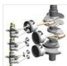
Il SOHC con design unico a 9 valvole con bilancieri a rulli fornisce un attrito minimo offrendo una risposta dell'acceleratore più rapida e più durevole contro l'usura.
