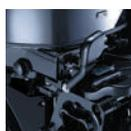
Leva del cambio montata anteriormente per facilitare le operazioni.
