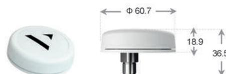
L'antenna compatta racchiude il modulo GPS NMEA2000 che comunica con il display l'accurata posizione dell'imbarcazione usando i segnali GPS/GNSS con un refresh di 10Hz e 72 canali di ricezione. Installazione semplice plug-and-play senza calibrazione.
