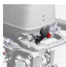
La leva del cambio è posizionata sulla porzione frontale del motore per un migliore funzionamento.
